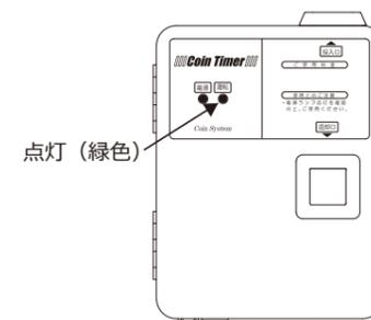
4. 残り時間が設定した動作時間の 10% になると、運転表示灯（緑色）が点滅します。
