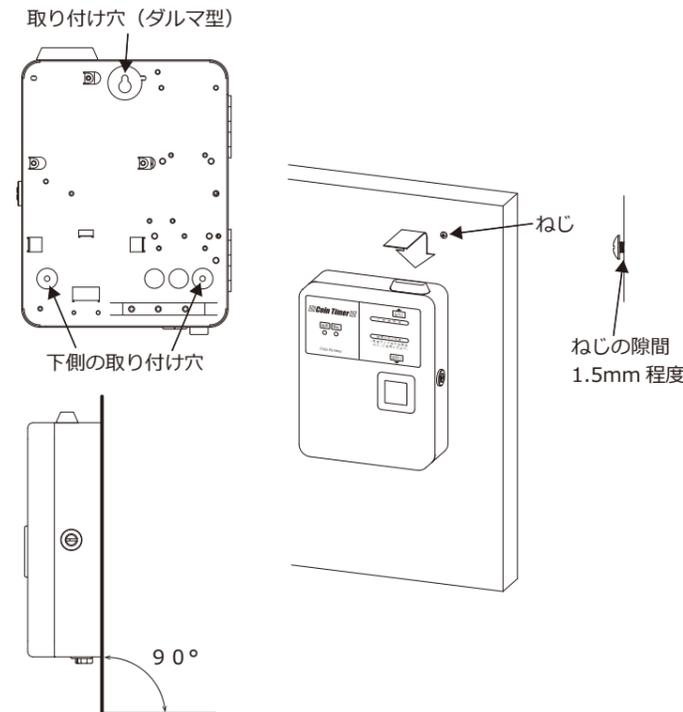
4. コインタイマーを水平に位置調整を行い、下側の取り付け穴 2ヶ所を付属の取り付け用ねじで、しっかりと固定してください。
